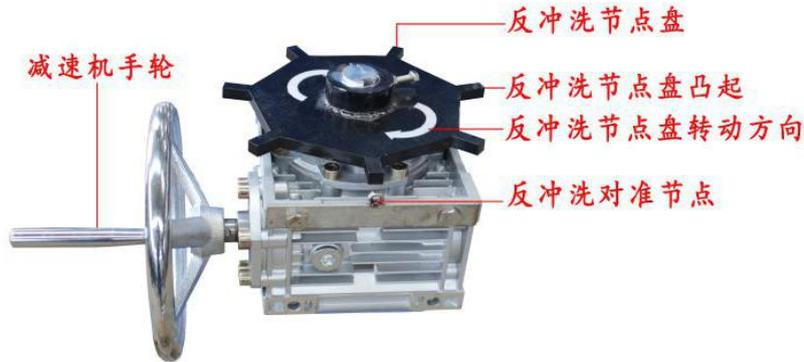
设备正常过滤时，无需转动减速机手轮，反冲洗节点盘处于静止状态（注：排污阀处于关闭状态）；
